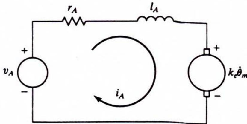
**电流放大器式电机驱动器:** 用电机驱动器控制电机转矩，驱动电路通过检测电枢电流不断调节电源电压使通过电枢的电流为期望电流。
