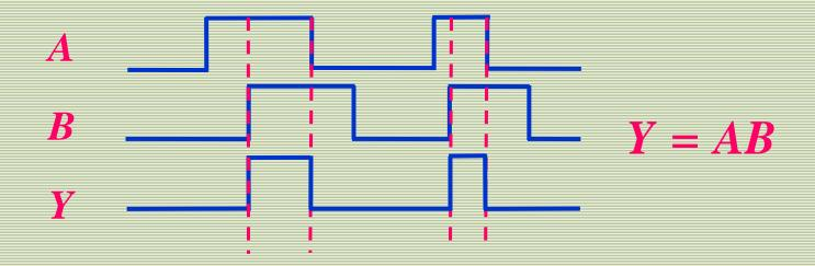
形象直观地表示了变量取值与函数值在时间上 的对应关系。
