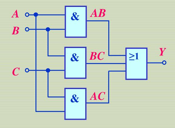
表达式与逻辑图有十分简单而准确的对应关系。
